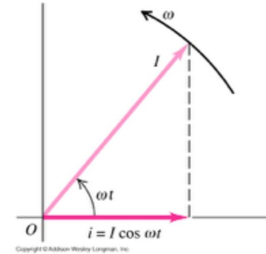
Dependência temporal da voltagem:  $\hat{V} = \bar{V} e^{i\Omega t}$  onde  $\bar{V} = V_0 e^{i\phi}$
